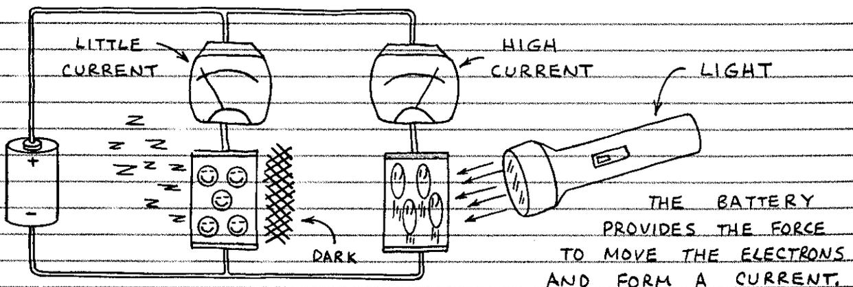
□ MORE ABOUT PHOTORESISTOR OPERATION — HERE ARE SOME IMPORTANT ASPECTS OF PHOTORESISTOR OPERATION :
