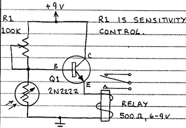
RELAY IS ACTUATED ONLY WHEN THE PHOTORESISTOR IS DARK.
