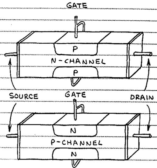
□ JUNCTION FET OPERATION — THE ARRANGEMENT BELOW SHOWS HOW AN N-CHANNEL FET WORKS. A NEGATIVE GATE VOLTAGE CREATES TWO HIGH RESISTANCE REGIONS (THE FIELD) IN THE CHANNEL ADJACENT TO THE P-TYPE SILICON. MORE GATE VOLTAGE WILL CAUSE THE FIELDS TO MERGE TOGETHER AND COMPLETELY BLOCK THE CURRENT. THE GATE-CHANNEL RESISTANCE IS VERY HIGH.
